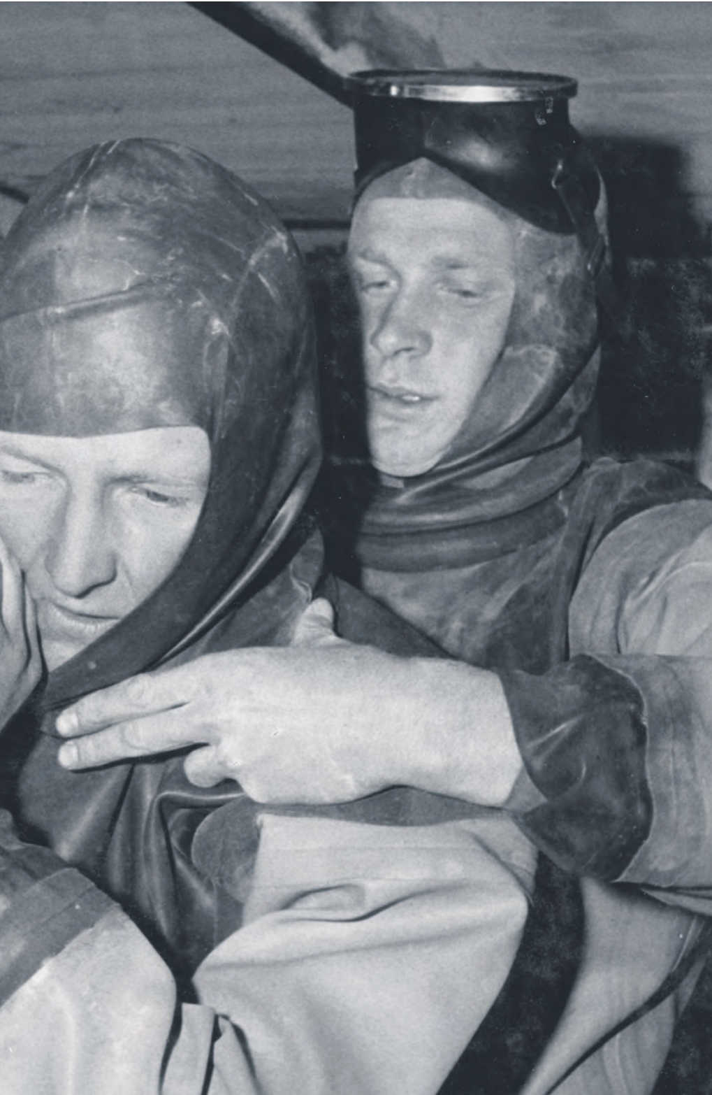
Øverst: Den grønne svømmedragt består af et stykke, således at frømanden må kravle ind i dragten gennem halsåbningen, der er lavet af så stærkt og smidigt gummi, at den kan udvides tilstrækkeligt. Dragten lukkes endeligt af med en hætte, der fastgøres til dragten over en halsring ved hjælp af to gummi-bånd. På billedet sættes hættens på plads. Foto: Sven Gjørting / Scanpix
