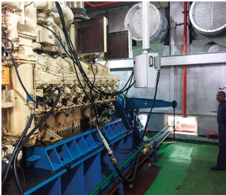
Danmark har doneret en testbænk, så den kenyanske flåde nu selv kan vedligeholde og reparere skibenes motorer.
