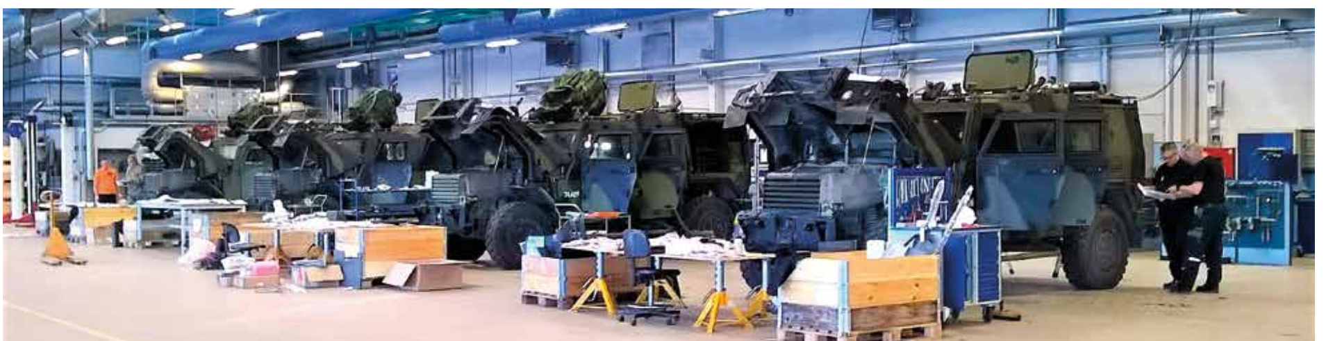
Forsvarets Hovedværksted har stået for serieindbygningen af HTK i Eagle 4-køretøjerne, som her er linet op i forbindelse med indbygningen. Privatfoto.
