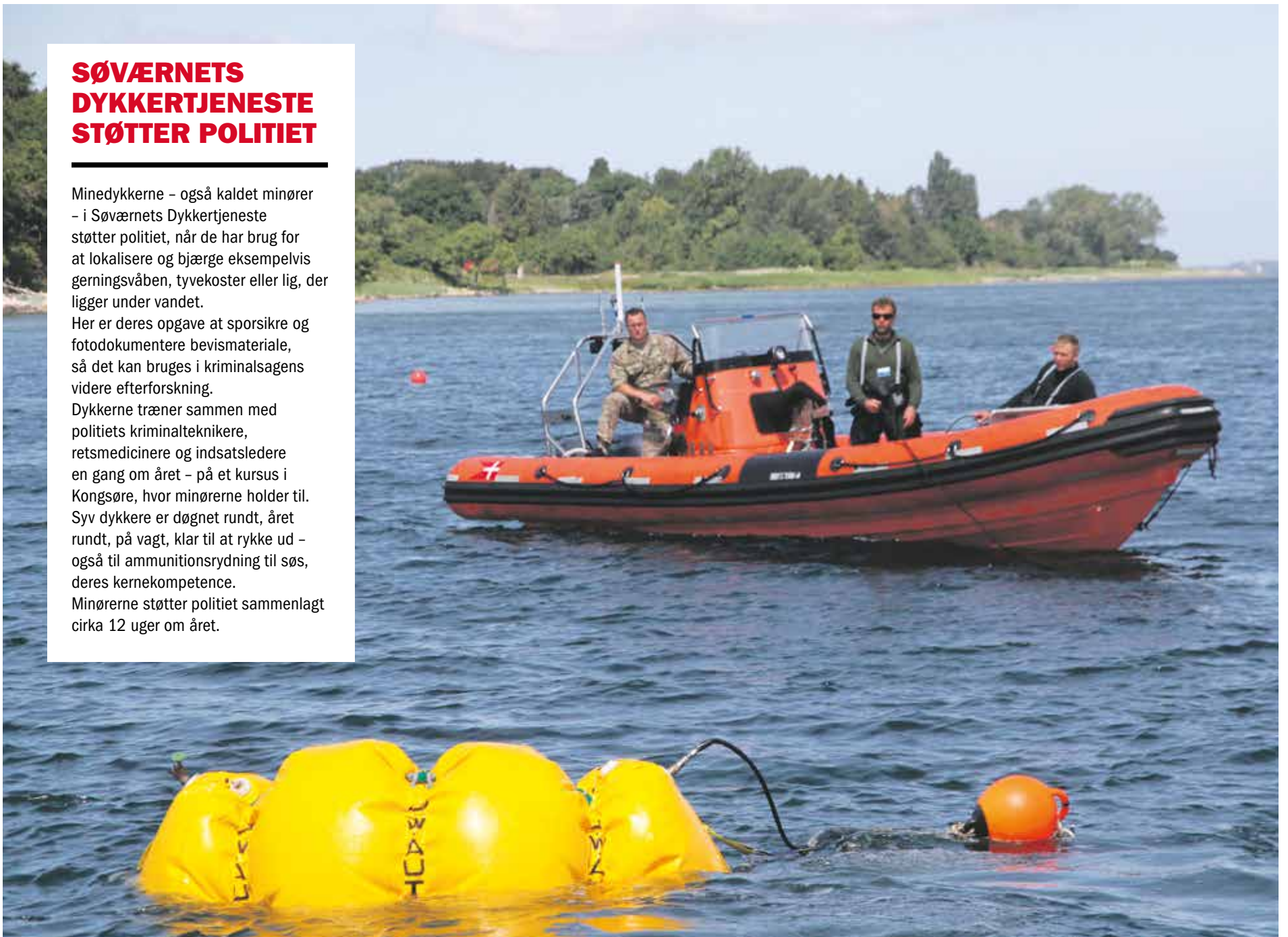
Den gule flydeballon kan løfte op til to tons og er derfor et vigtigt redskab, når dykkerne skal bjærge eksempelvis en personbil, som ligger på havbunden.
