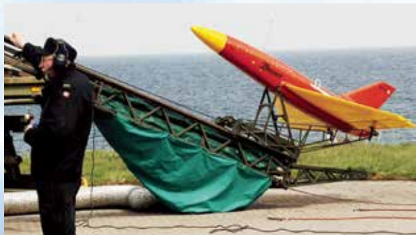
Drone på rampen klar til at blive sendt afsted. Den styrer selv kursen ved hjælp af GPS, og undervejs sender den hele tiden information om sin position. Foto: Kurt Hevang
