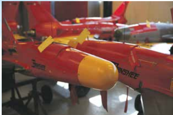
Banshee-droner findes i forskellige konfigurationer. For eksempel med wankel- eller jetmotor. Foto: Morten Mariani
