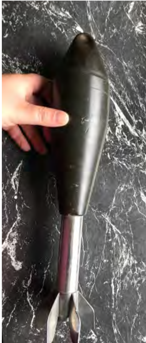
Geværgranat, beregnet til panserbekæmpelse inden for 100 m. Granaten spændes på piben af et gevær og udskydes ved hjælp af en særlig patron. Denne er ligeledes indleveret til Politi.
